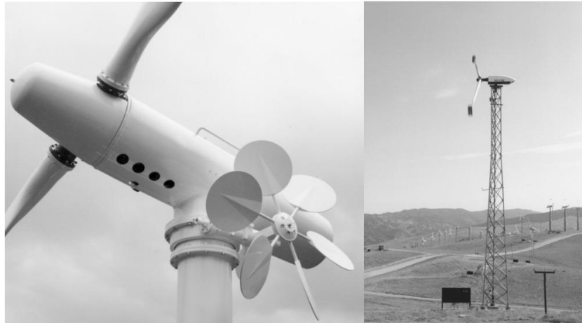
Figura 14: De izquierda a derecha, aerogenerador tipo Aeroman (1985) con guiñada fan-tail wheel y aerogenerador americano ESI (1985) con guiñada libre [7].
