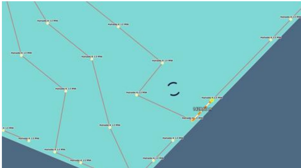
Figura 37. Borde sureste: separación mínima \sim 1.429\text{ m} ( \approx 6,5\text{ D} ), próxima al mínimo del DCO. Fuente: elaboración propia sobre 4C Offshore.
