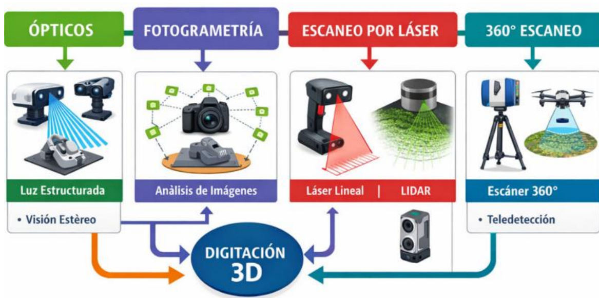
Figura 10. Métodos ópticos de ingeniería inversa
