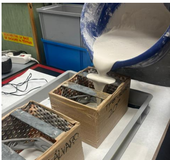
Figura 86. Llenado de las cajas de contención usando el revestimiento cerámico
