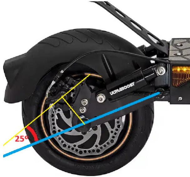
Figura 61. Ángulo de aplicación de la fuerza de frenado
