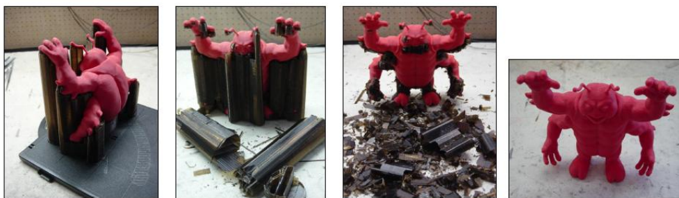
Figura 41. Proceso de eliminación de soportes
