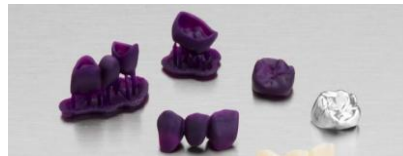
Figura 48. Fabricación al modelo perdido para la fabricación de prótesis dentales
