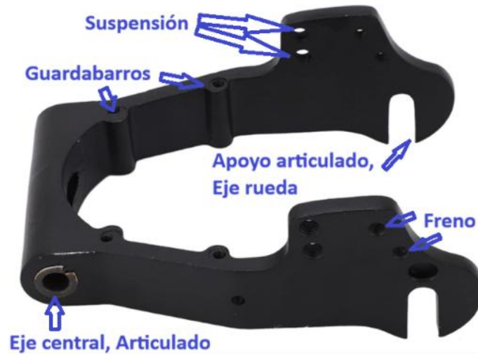
Figura 60. Esquema para funcionalidad de los orificios
