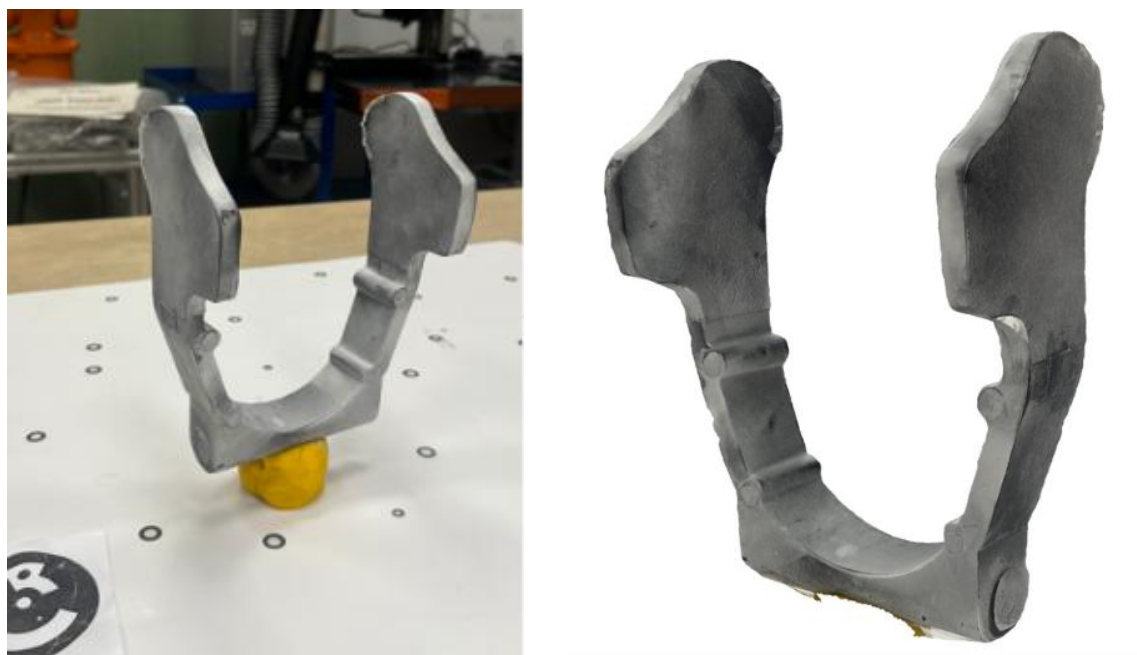
Figura 52. Configuración 3 del entorno para fotogrametría y malla tridimensional obtenida
