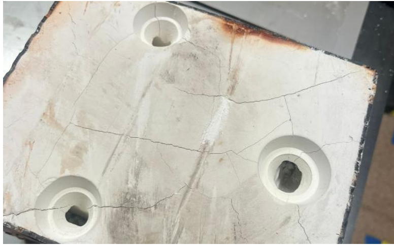
Figura 89. Presencia de cenizas en los canales de alimentación
