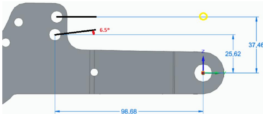
Figura 64. Sistema de cotas para el cálculo de la fuerza de suspensión
