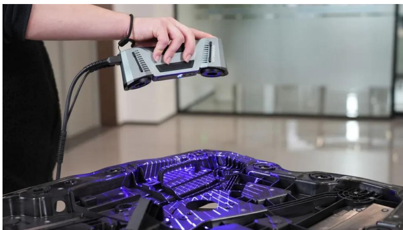
Figura 17. Proyección de rejilla láser sobre pieza
