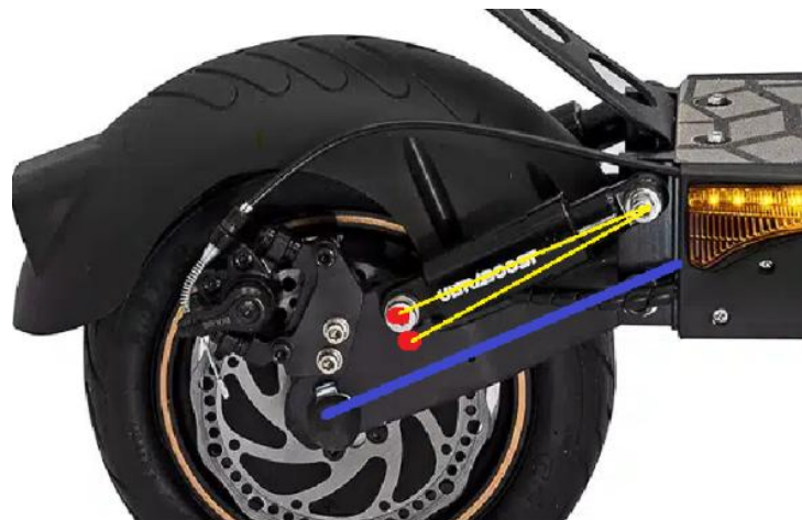
Figura 63. Ángulo de inclinación de la suspensión frente al eje longitudinal
