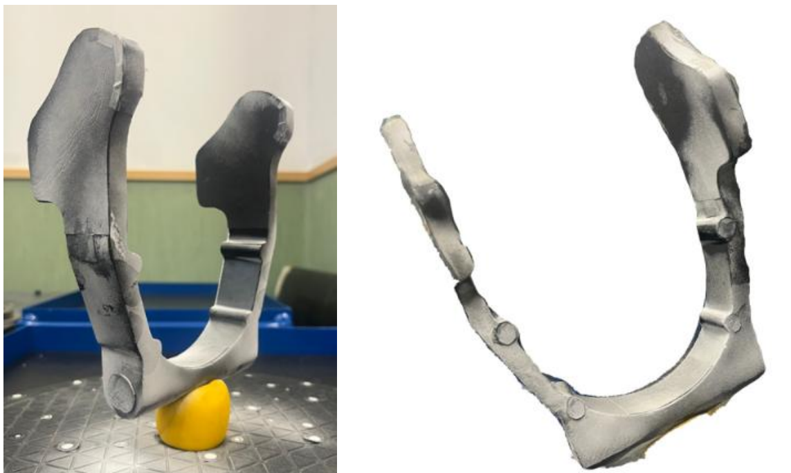
Figura 51. Configuración 2 del entorno para fotogrametría y malla tridimensional obtenida
