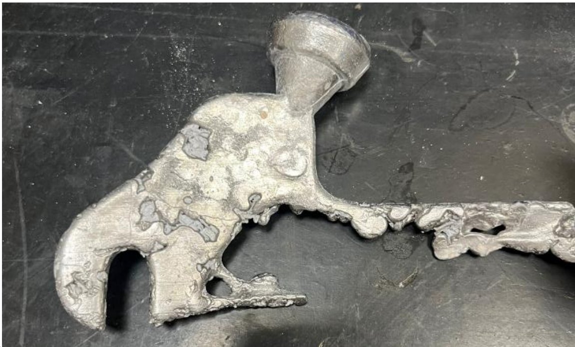
Figura 95. Resultado en detalle de la fundición con inclusiones de ceniza
