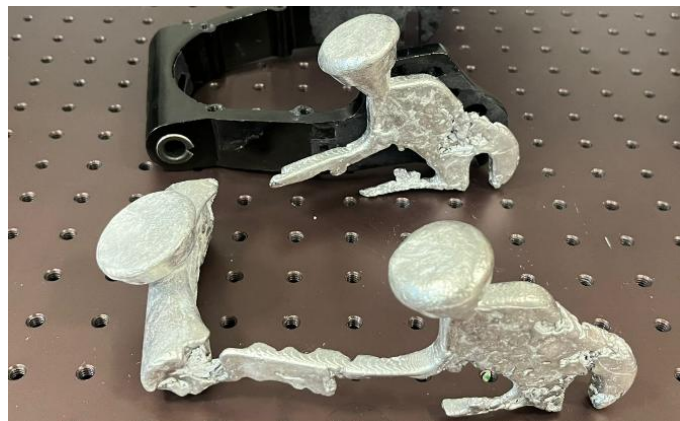
Figura 3. Resultado de la colada de aluminio (L-2560)
