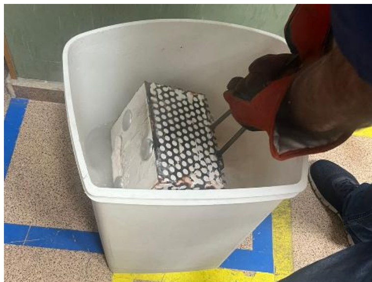
Figura 93. Desmoldeo del revestimiento cerámico mediante agua
