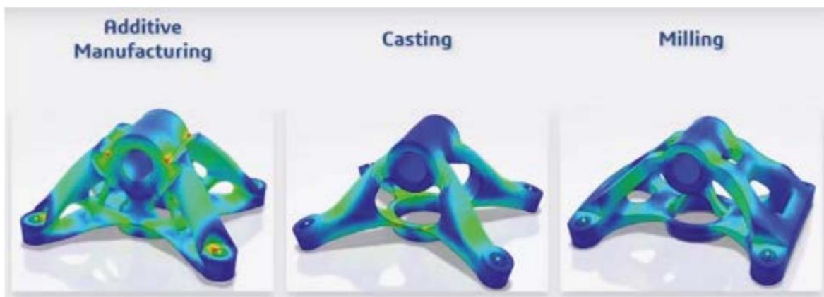
Figura 18. Comparación de resultados de diseño generativo con distintos procesos de fabricación [16]
