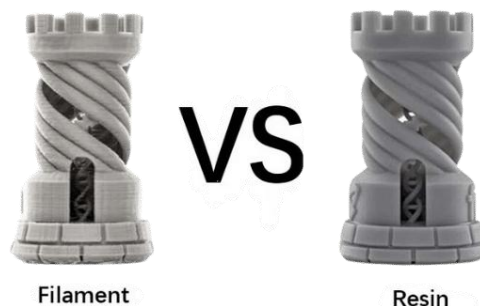
Figura 44. Comparativa impresión con filamento y resina
