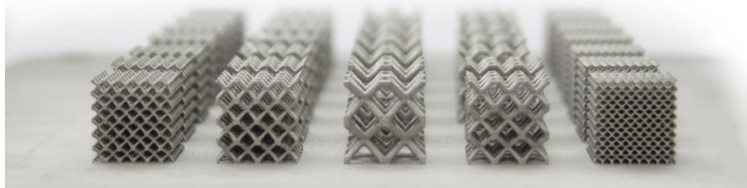
Figura 43. Relleno interior modelos 3D (estructuras lattice)
