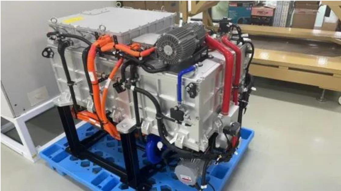
Figura 19:Pila de combustible PEM zzSMRT
