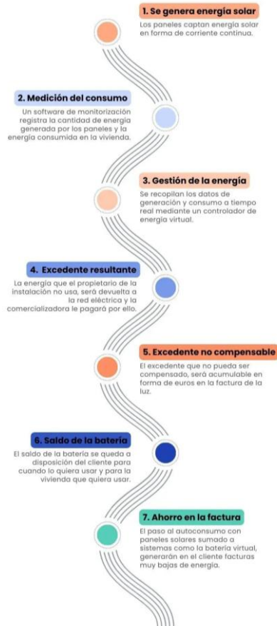
Figura 26: Funcionamiento batería virtual
