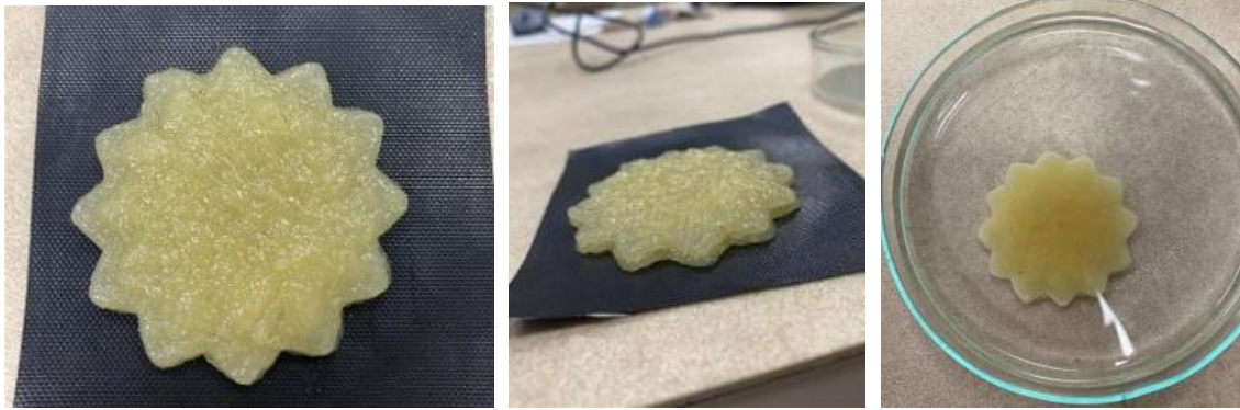
Figura 31: Primera estrella impresa: vista superior (izquierda); vista frontal (centro); pieza sumergida en el baño de \text{CaCl}_2 (derecha).
