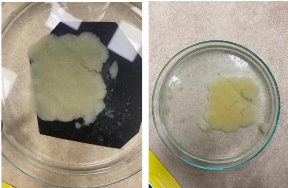
Figura 26: Ensayo 6 — resultado. Desintegración parcial al separar del film (izquierda); pieza completamente rota (derecha). El pH 2,5 impidió la formación de membrana estable.
