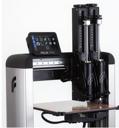
Figura 4: Impresora FELIX Food 1.6 Switch Head 3D Printer empleada en los ensayos experimentales. Fuente: [14].
