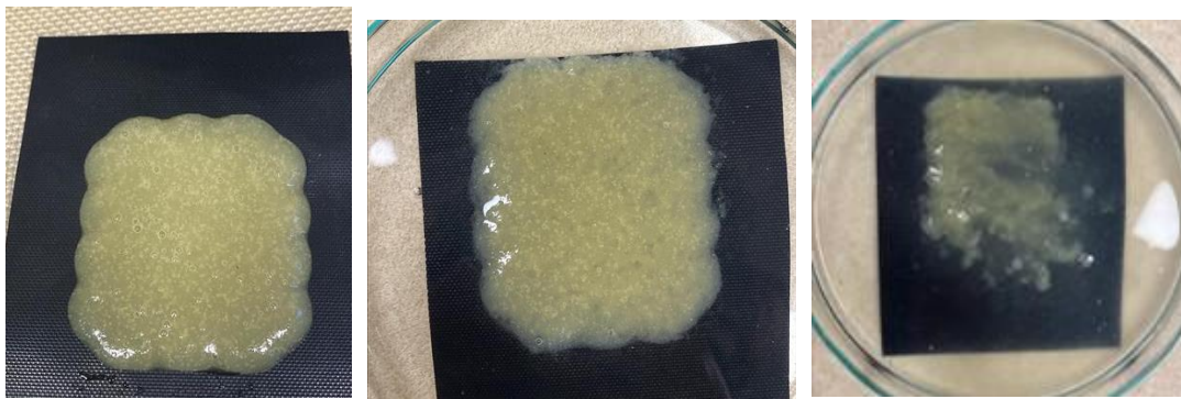
Figura 20: Ensayo 1: pieza recién impresa; en el baño de \text{CaCl}_2 ; descompuesta. La baja concentración de alginato y el pH ácido impidieron la gelificación.
