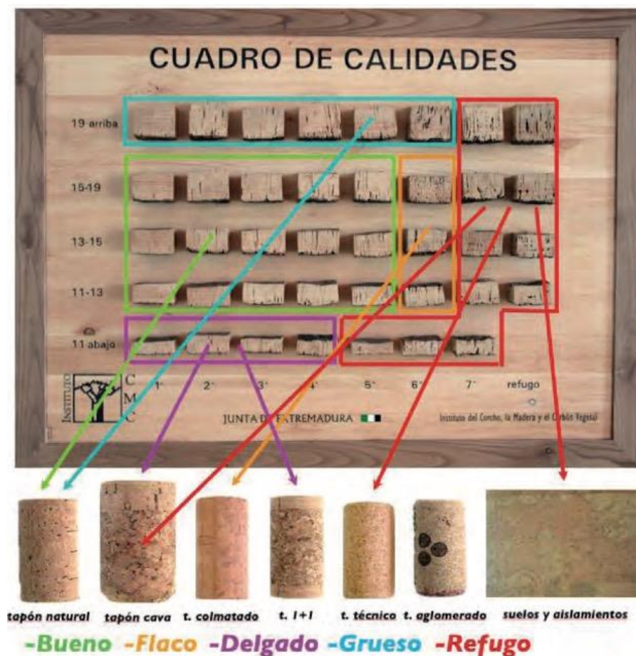
Figura 7 - Clasificación de la calidad del corcho según calibre y defectos, y su relación con los distintos tipos de producto.
