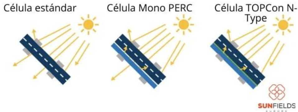
Figura 3. Esquema comparativo de las estructuras de célula PERC y TOPCon. Fuente Sunfields Europe [41]
