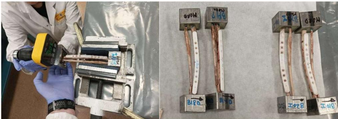
Figura 8 Ensayo de torsión manual sobre muestras de hueso de búho y detalle de estas.
