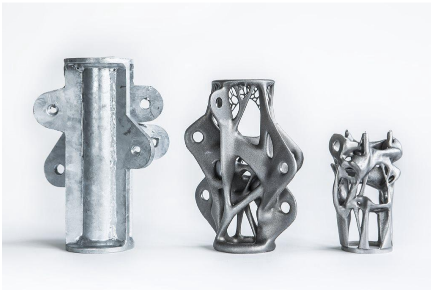
Ilustración 8: Fases de diseño generativo
