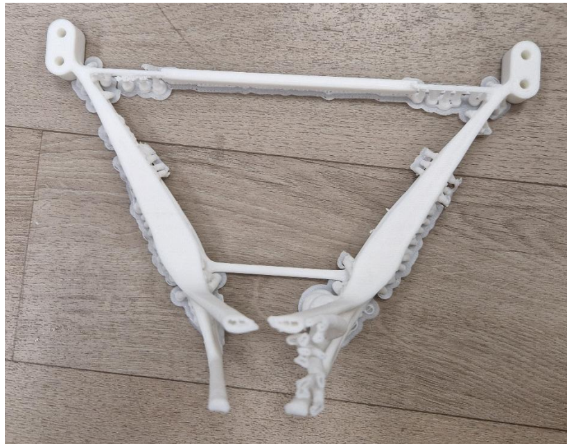
Ilustración 87: Error de impresión
