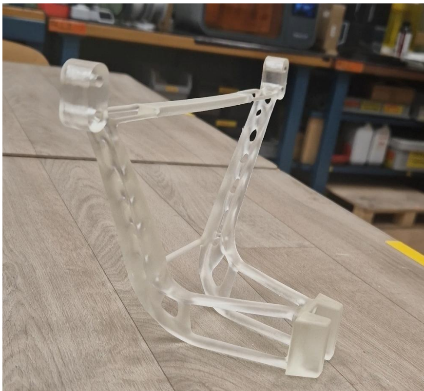
Ilustración 93: Araña impresa en SLA con soportes
