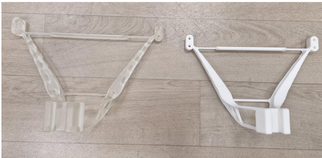
Ilustración 2: Araña optimizada impresa en 3D
