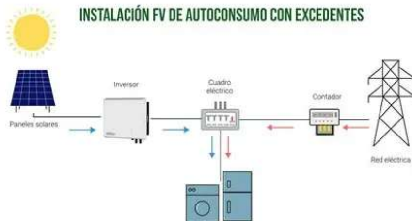
Ilustración 9: Representación visual de una instalación de autoconsumo con excedentes
