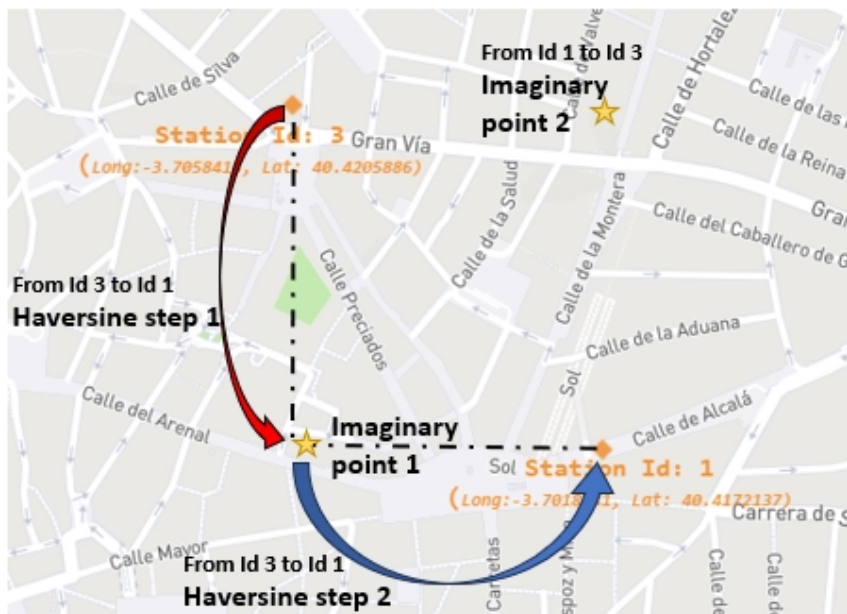
Figura 3.11: Representación gráfica de cálculo de la distancia basado en una combinación de las distancias Haversine y Mahattan. Fuente: Elaboración propia.
