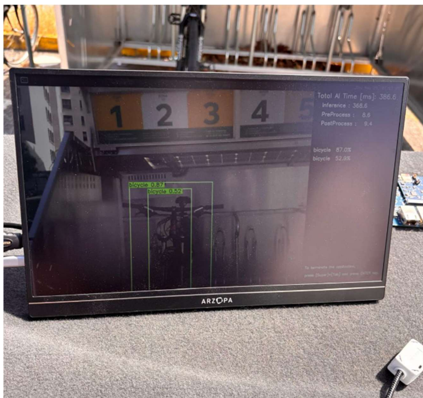
Ilustración 26. Resultado obtenido por el sistema en un escenario con varias bicicletas presentes simultáneamente en la escena.
