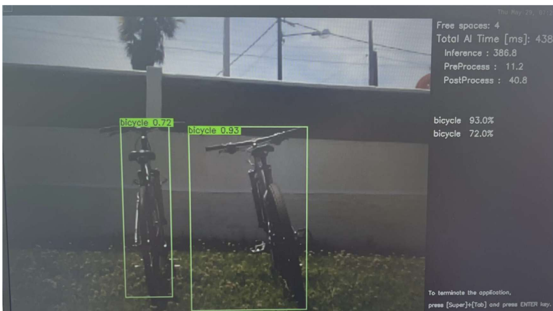
Ilustración 13 y 14: Detección de 2 bicicletas y Visualización en pantalla del número de plazas libres calculado por el sistema
