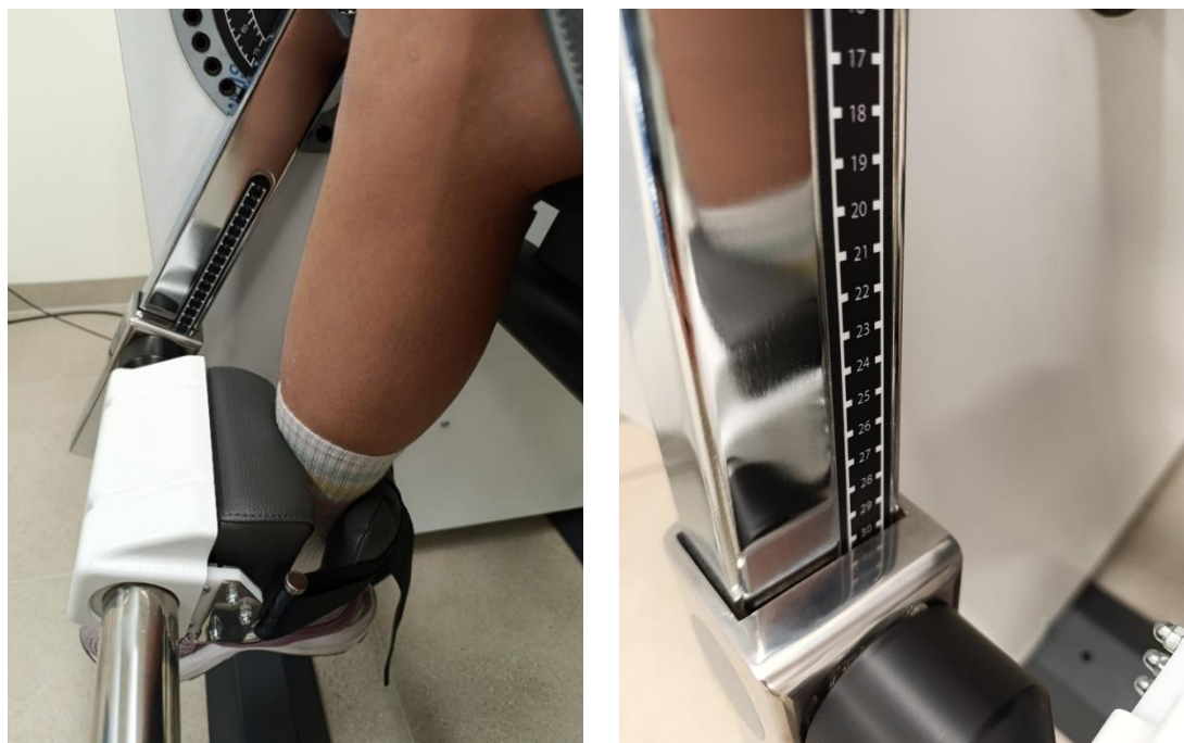
Figura 18. Agarre del dispositivo en pierna (izquierda) y brazo de palanca de 30 cm (derecha).
