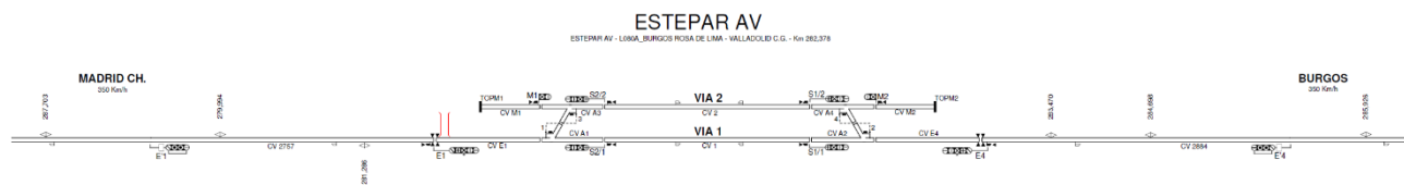
Ilustración 22: Esquema de vía de "Estepar" Fuente: ADIF
