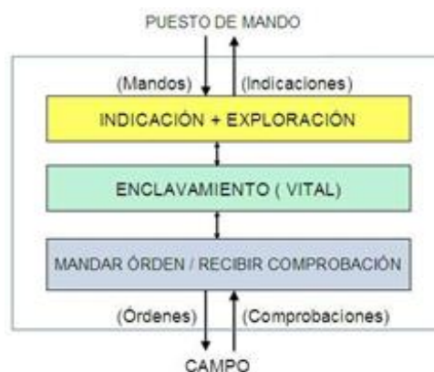
Ilustración 1: Estructura de un enclavamiento Fuente: Elaboración propia
