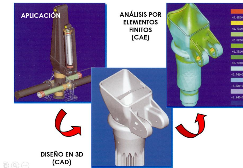
Figura 29. Ejemplo de aplicación de programas CAD y CAE
