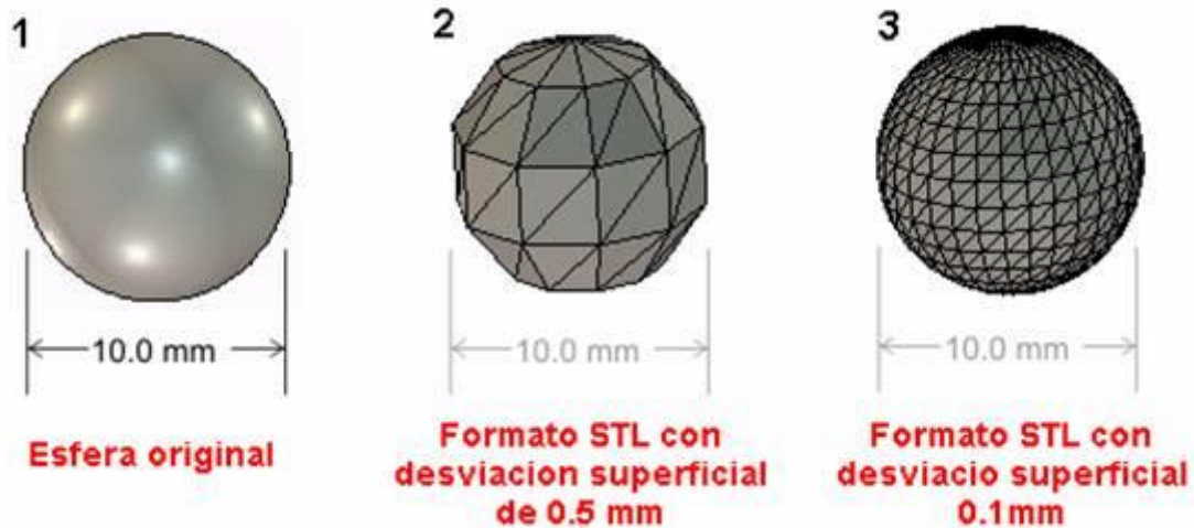
Figura 34. Distintas configuraciones de la tolerancia de cuerda
