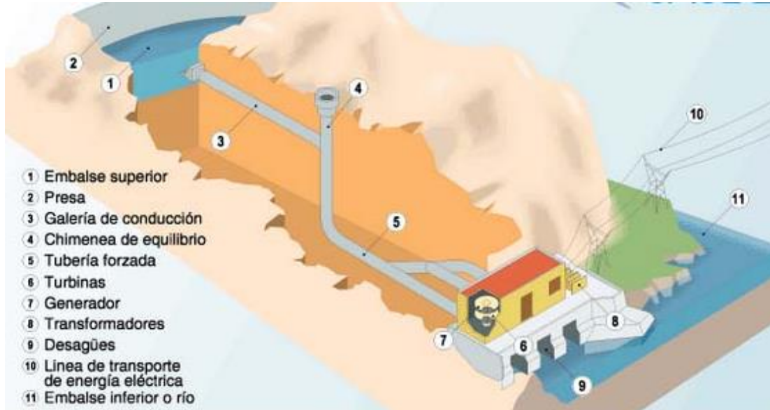
Fig 5. Central hidráulica de bombeo.
