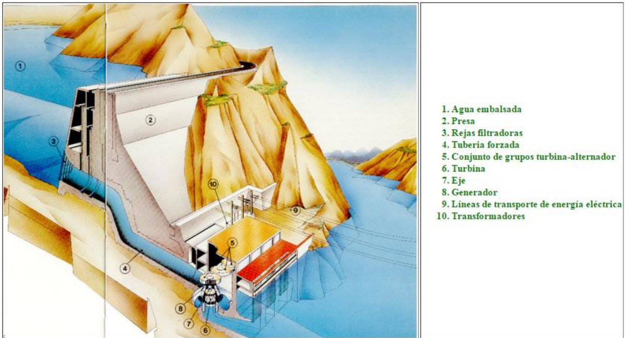
Fig 4. Central de agua embalsada.
