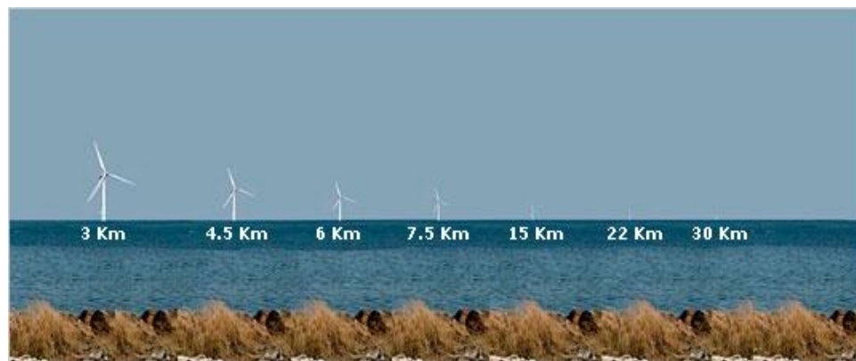
Ilustración 5.1 Visibilidad de los aerogeneradores en función de la distancia a costa. “Antonio Narejos word press”
