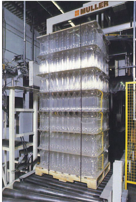
Figura 48: Ejemplo de una configuración en pallets de botellas de plástico
