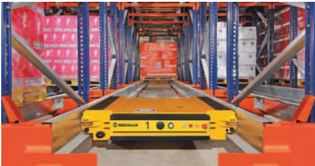
Figura 80: Detalle del Shuttle dentro de un rack
