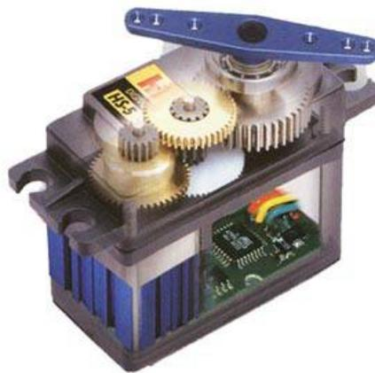
ILUSTRACIÓN 51 - ESQUEMA CONSTRUCTIVO DE UN SERVOMOTOR
