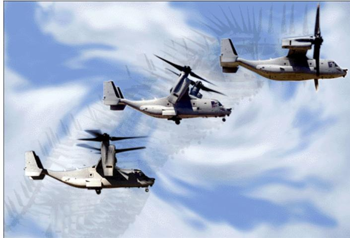
ILUSTRACIÓN 4 - TRANSICIÓN DE DESPEGUE VERTICAL A VUELO HORIZONTAL DEL BELL BOEING V22 OSPREY
