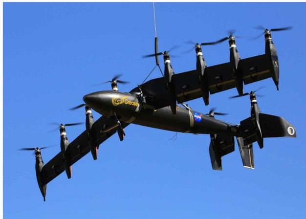
ILUSTRACIÓN 7 - PROTOTIPO A ESCALA 1:2 DEL GL10 "GREASED LIGHTNING"
