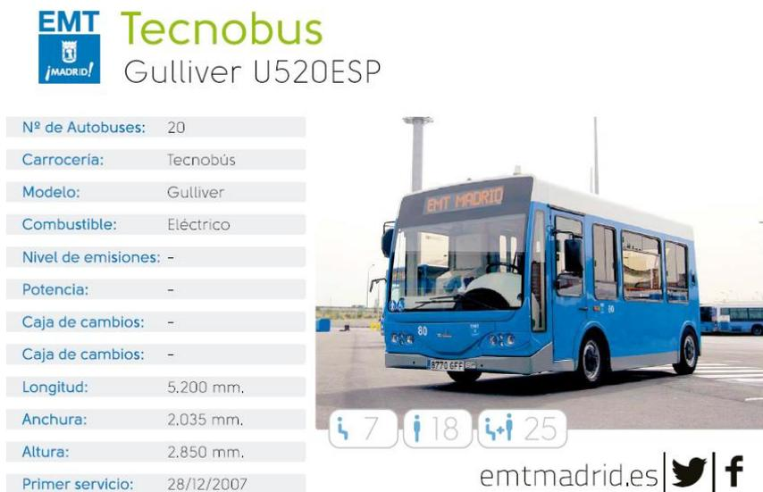
**Figura 4.1.** Especificaciones técnicas autobús Gulliver [2].
