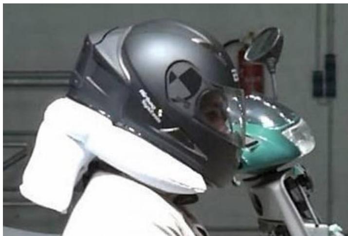
Figura 24. Casco de APC Systems tras su inflado. [33].
