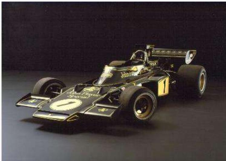
Ilustración 2.29 Forma de cuña. Lotus 72 D 1972. Fuente: <https://prezi.com/by9te9niqaqs/aerodinamica-en-la-formula-1/>
