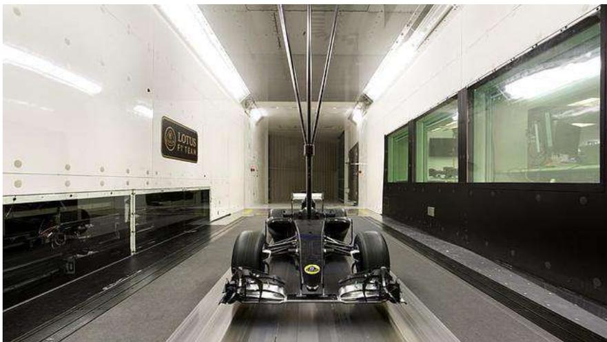
Ilustración 2.90 Modelo en suelo rodante. Fuente: <http://www.abc.es/Media/201507/05/tunel-viento--644x362.jpg>
