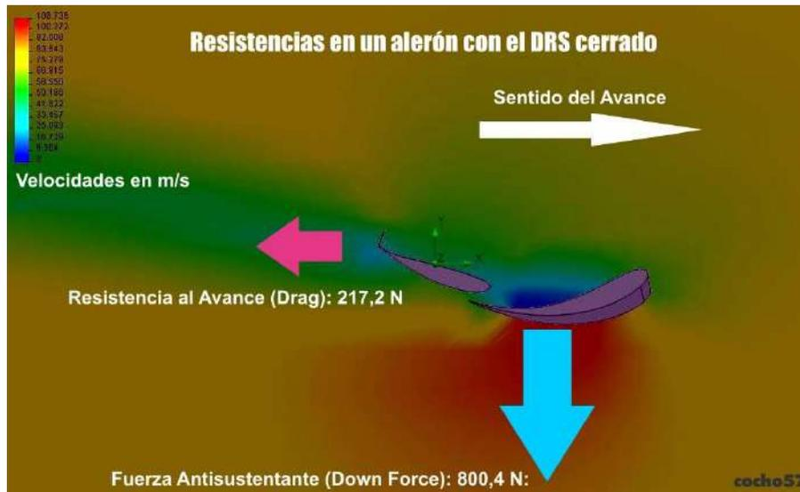
Ilustración 2.135 DRS cerrado. Fuente: <http://k31.kn3.net/C0F5840CB.jpg>
