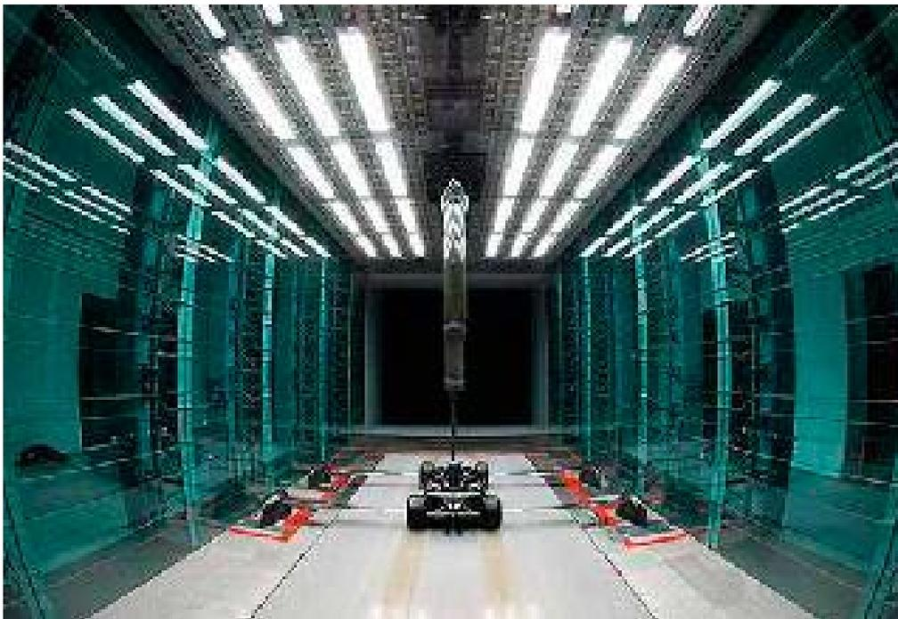
Ilustración 2.88 Sección de prueba del túnel de Toyota. Fuente: <http://1.bp.blogspot.com/-vO7zLTKZ5GE/UiGbMxGqINI/AAAAAAAAAB7o/NLHaqOfL45c/s640/tunel-viento-toyota-f1-salida.jpg>
