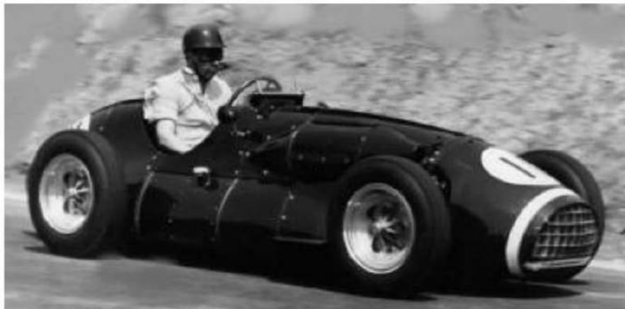
Ilustración 2.12 Chasis con forma de gota. Connaught A 1952. Fuente: <https://prezi.com/by9te9niqaqs/aerodinamica-en-la-formula-1/>
