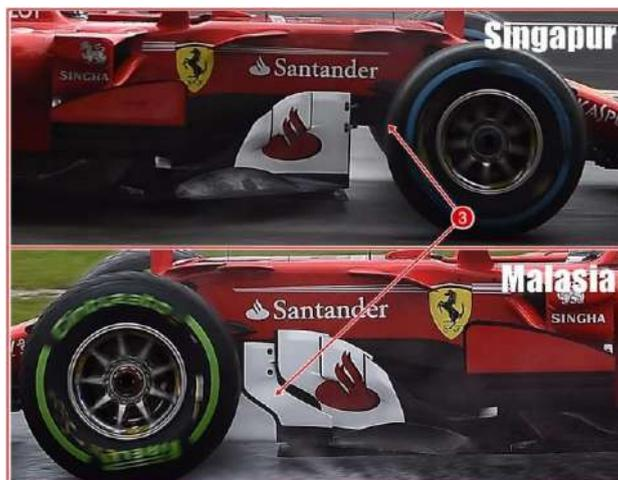
Ilustración 2.106 Aletas de pontón. Fuente: [https://static.motor.es/fotos-noticias/2017/10/min652x435/video-analisis-tecnico-gp-malasia-f1-201739944\\_2.jpg](https://static.motor.es/fotos-noticias/2017/10/min652x435/video-analisis-tecnico-gp-malasia-f1-201739944_2.jpg)
