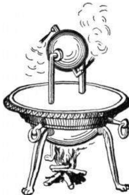
Ilustración 1.5 Eolípila de Herón. Fuente: <http://quhist.com/wp-content/uploads/2012/07/Eolipila-197x300.jpg>
