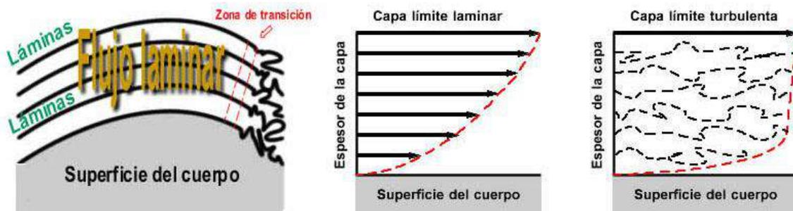
Ilustración 2.73 Esquema del flujo del fluido y Capa límite. Fuente:
