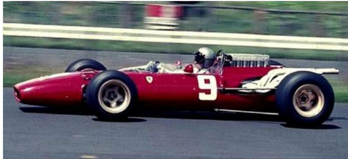
Ilustración 2.20 Forma de cigarro. Ferrari 312 1966. Fuente: <https://prezi.com/by9te9niqaqs/aerodinamica-en-la-formula-1/>
