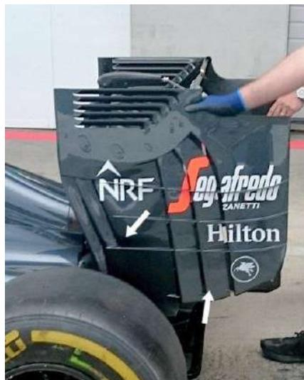
Ilustración 2.127 Aletas con rejillas. Fuente: <https://pbs.twimg.com/media/CmNvvCHWAAA2z5t.jpg:large>
