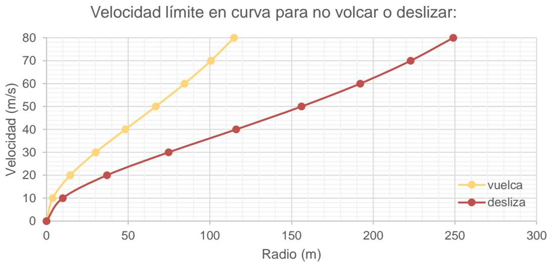
Gráfica 4.3 Velocidad límite en función del radio de la curva para no deslizar o volcar con y sin alerón. Fuente: Propia.
