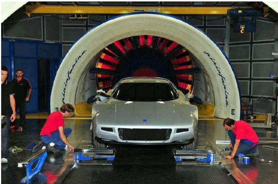
Ilustración 2.84 Modelo real en túnel de viento. Fuente: <http://www.blogcdn.com/es.autoblog.com/media/2010/08/a42b.jpg>
