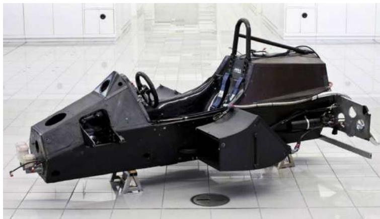
Ilustración 2.37 Monocasco de fibra de carbono. Fuente:
