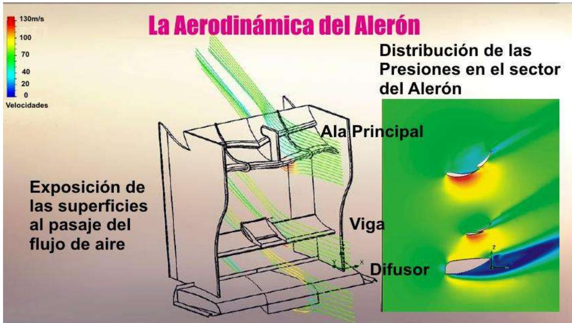
Ilustración 2.118 Alerón trasero. Fuente: <http://k40.kn3.net/14BD3E19C.jpg>
