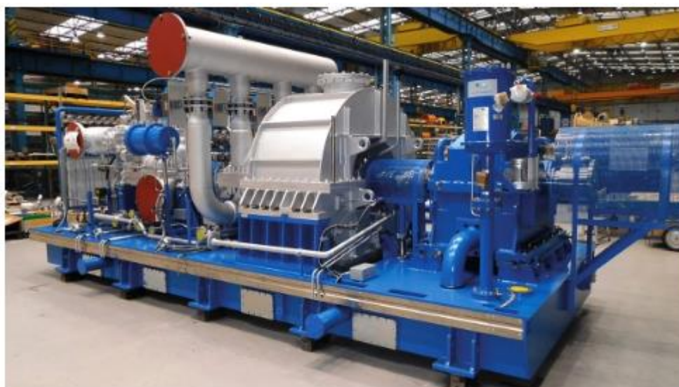
Figura. 23: Turbina de vapor elegida
