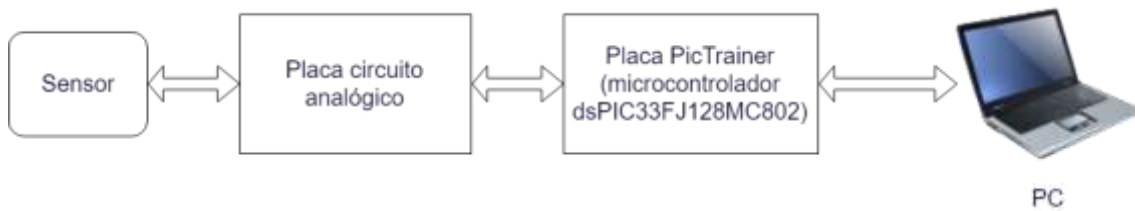
Figura 60. Diagrama de bloques del sistema completo para medida de PPG
