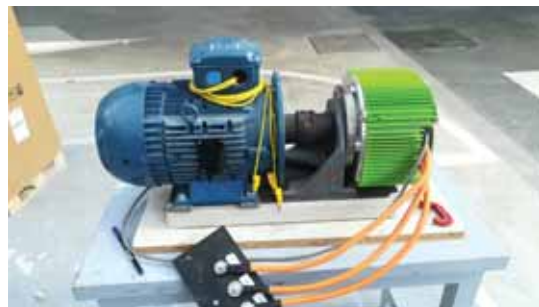
(b) Imagen del banco de potencia terminado
