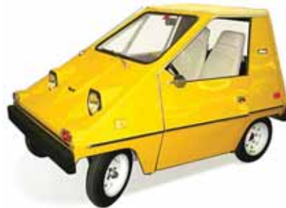
(b) Citycar, vehículo eléctrico con motor DC [65]
