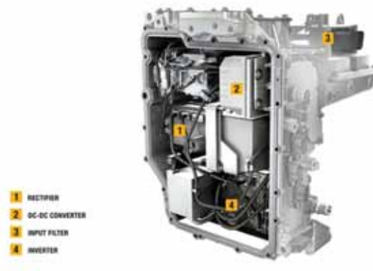
Figura 1.20: Ilustración de los componentes principales del regulador de un vehículo eléctrico [86]
