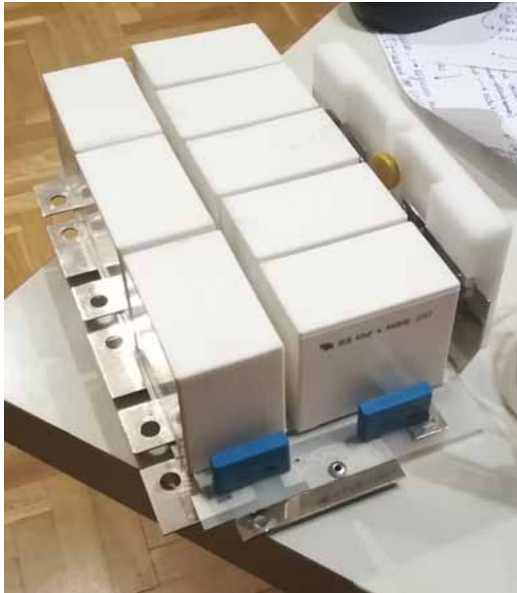
Figura 3.35: Imagen de los condensadores empleados
