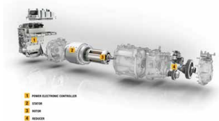
Figura 1.7: Ilustración de los componentes principales de un vehículo eléctrico [86]
