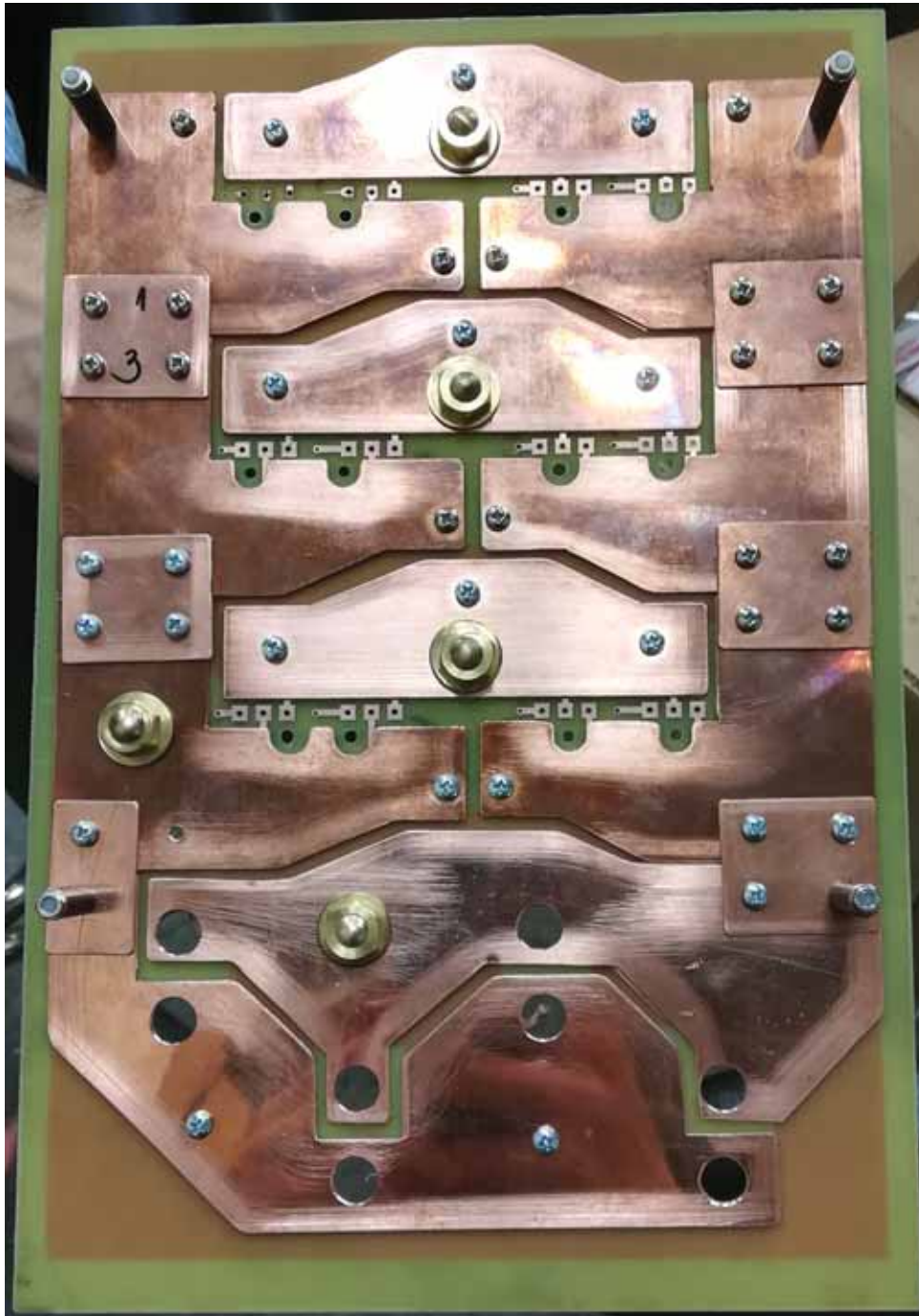
Figura 3.46: Imagen de la planta baja del inversor sin sus componentes, solo las conexiones y orificios hechos.
