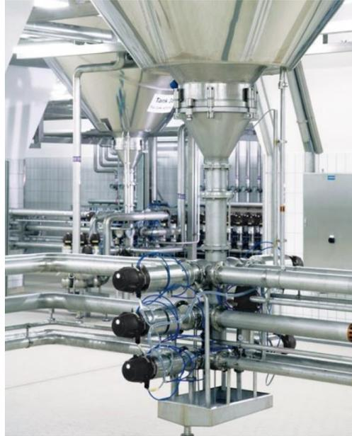
Ilustración 8: Bloque de válvulas eco-matrix
