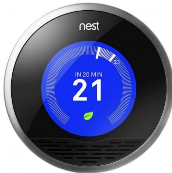
Ilustración 12: Termostato inteligente de Nest [XXIII]
