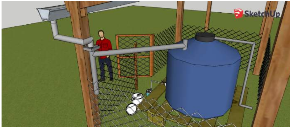
Ilustración 20- Conexiones canalón- tubería y el divisor de primeras aguas
