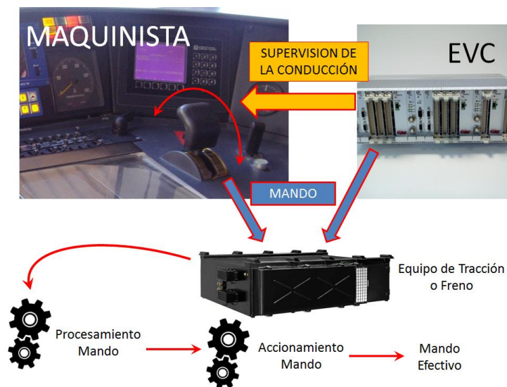
Figura 2: Esquema de diferímetros Tracción/Freno
