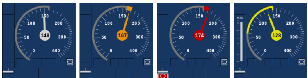
Figura 3: DMI en FS. Supervisión de Velocidad [5]
