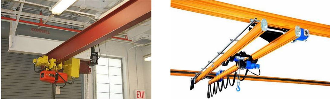
Figura 10: Monocarriles con polipastos. Puente grúa.
