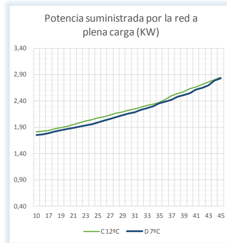
Figura 45: Potencia térmica en modo frío consumida de la red a plena carga, P_{sum_i}(Text^{\circ}C) . Fuente: Elaboración propia
