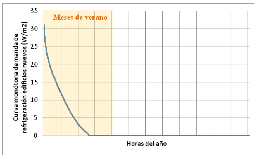
Figura 19: Curva monótona de demanda térmica horaria de refrigeración, edificios nuevos. Fuente: Elaboración Propia
