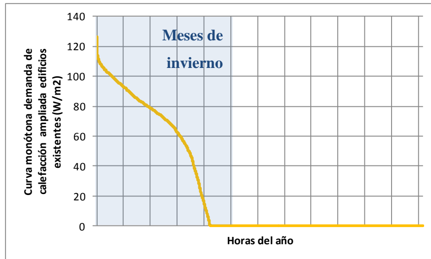
Figura 14: Curva monótona de demanda térmica horaria de calefacción, edificios antiguos. Fuente: Elaboración Propia
