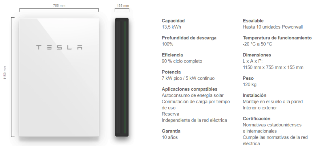
Figura 52: Características técnicas Powerwall Tesla. Fuente: Tesla
