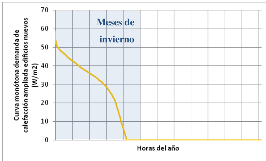
Figura 18: Curva monótona de demanda térmica horaria de calefacción, edificios nuevos. Fuente: Elaboración Propia
