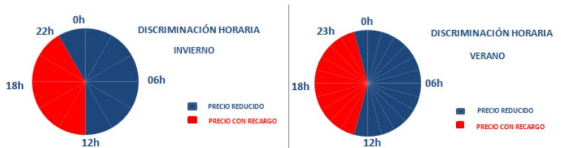
Figura 51: Discriminación horaria invierno y verano, horarios de precios reducidos y con recargo. Fuente: Esios
