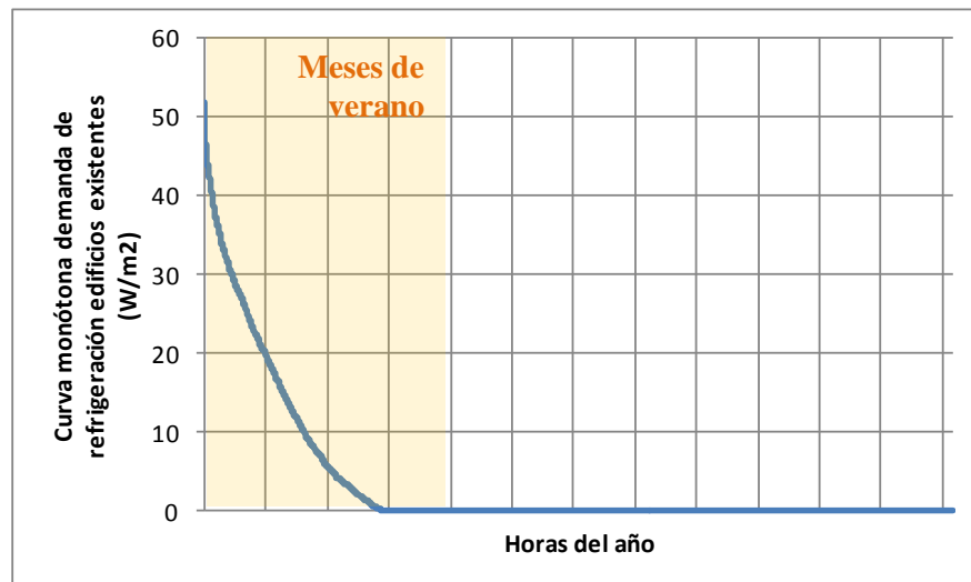
Figura 15: Curva monótona de demanda térmica horaria de refrigeración, edificios antiguos. Fuente: Elaboración Propia
