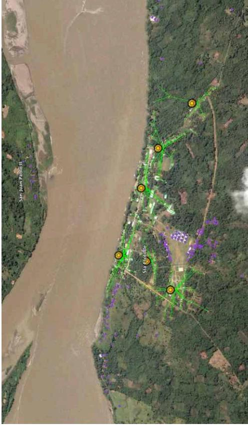
*Ilustración 76. Demanda alta - Caso II.a SK 0.21: detalle electrificación Santa Clotilde*
