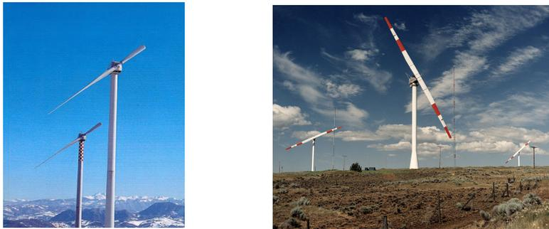
Figura 13. Aerogenerador monopala y bipala [29][30]
