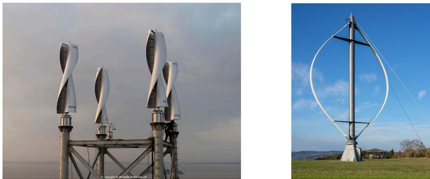
Figura 11. Aerogeneradores con rotor Savonius y Darrieus [25] [26]
