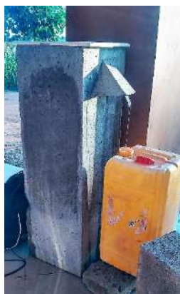
Ilustración 4 Biofiltro de arena. Fuente: Héctor Castañon
