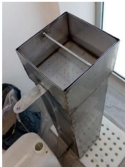
Ilustración 35 Filtro de bio-arena instalado en el IBFG, construido en acero inoxidable.
