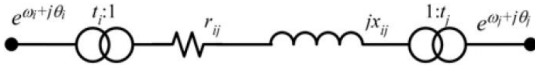
Figura 8. Esquema transformador con tensiones aplicadas cambio de variable (Tomada de [ECHV16]).
