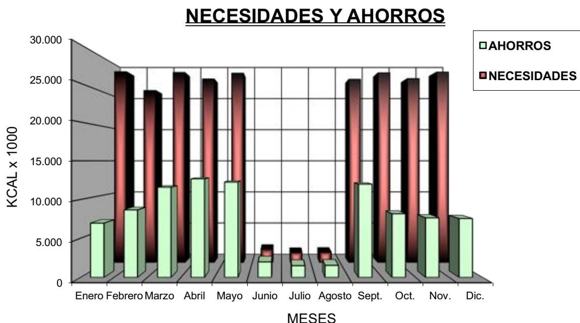
A continuación, se ha realizado el cálculo de la instalación geotérmica para diferentes bombas de calor geotérmico de distintas potencias. Se ha realizado un cálculo del porcentaje ahorrado y una longitud de captación, es en este cálculo donde encontramos la limitación de nuestra nave industriales ya que dispone de cuatro perforaciones de 100 metros para introducir las sondas a las que tenemos que limitar el cálculo.
