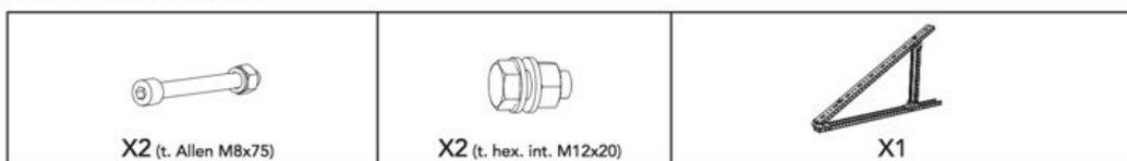
FIGURA 27. ELEMENTOS NECESARIOS PARA SOPORTE. FUENTE: INSTRUCCIONES DE MOTAJE VHM 2.1, CAPTADOR SOLAR COINTRA ÍCARO.
