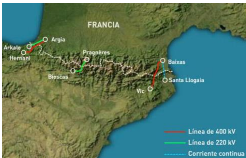
Figura 1: Interconexiones entre España y Francia [3]
