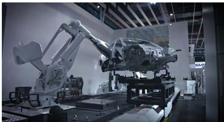
Figura 6: IRB 8700 levantando y transportando la carrocería de un coche
