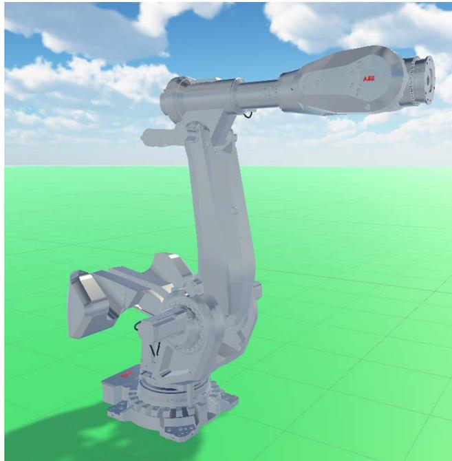
Figura 3: IRB 8700 importado completamente a Unity
