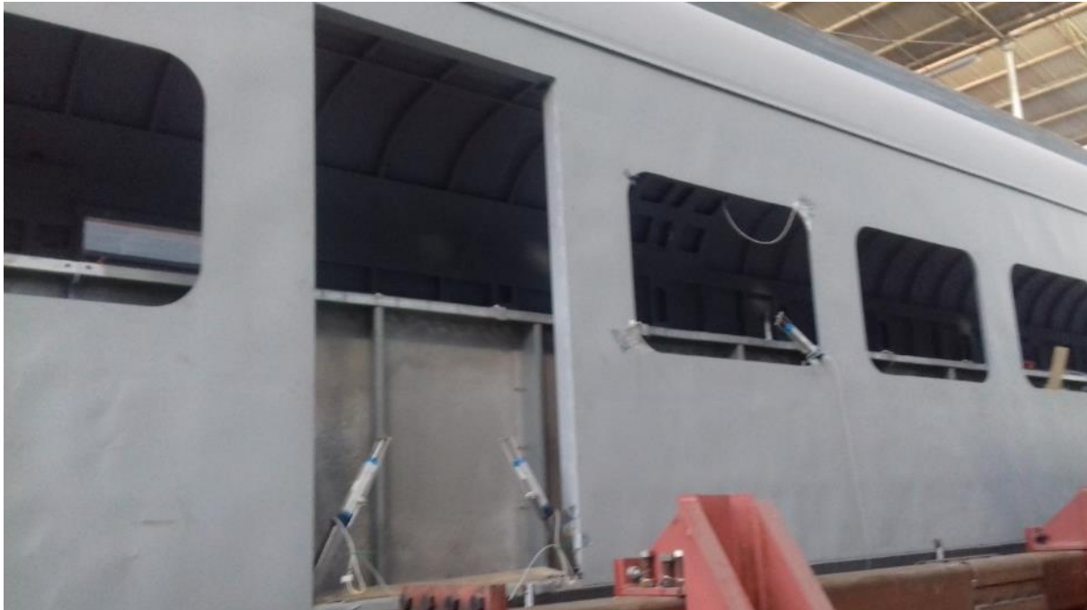
Ilustración 23: Detalle de la colocación de las LVDT en la puerta exterior izquierda junto baño.
