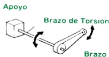
Figura 3.9: Esquema de barra de torsión
