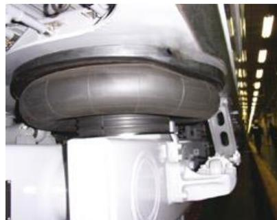
Figura 3.6: Balona neumática ferroviaria
