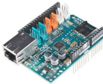
Ilustración 20. Diseño del prototipo: Ethernet Shield
