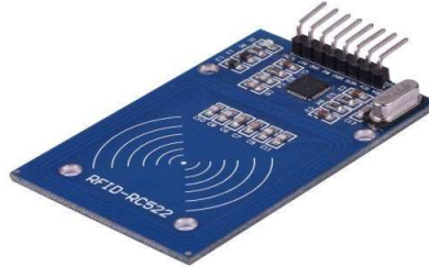
Ilustración 16. Diseño del prototipo: RC522
