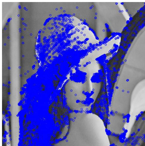
Figura 20. Puntos de interés con los algoritmos de Shi-Tomasi (izq.) y FAST (drcha.).
