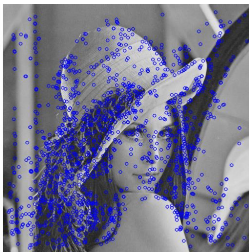
Figura 21. Puntos de interés con los algoritmos SIFT (izq.) y SURF (drcha.).
