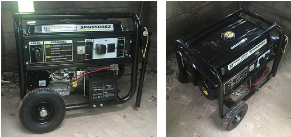
Ilustración 22. Grupo electrógeno a gasolina. Fuente: elaboración propia
