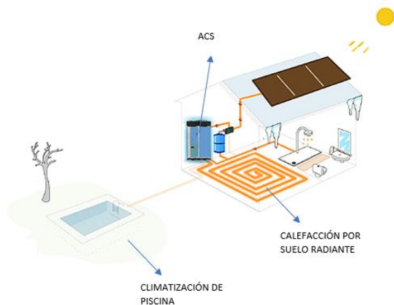
Ilustración 9: Esquema instalación solar térmica destinada a ACS, suelo radiante y climatización de piscina
