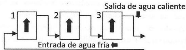
Ilustración 12: Esquema colectores solares con conexión en serie
