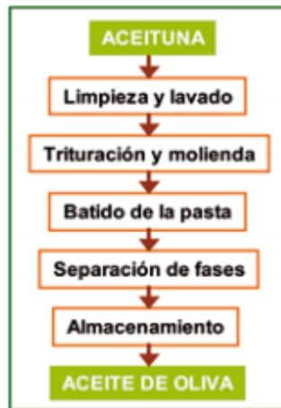
Figura 21. Fases del proceso de elaboración del aceite de oliva. [20]
