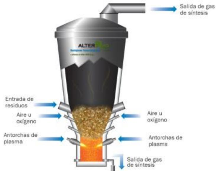
Figura 25. Reactor de gasificación por plasma.
