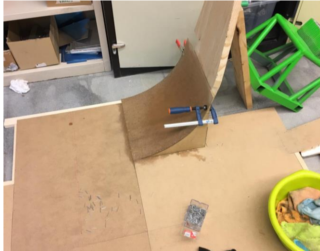
Figura 63 Proceso de doblado y unión del tablero
