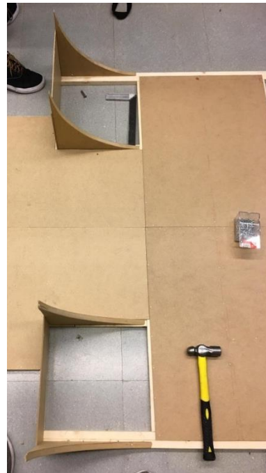
Figura 62 Cuñas unidas al tablero
