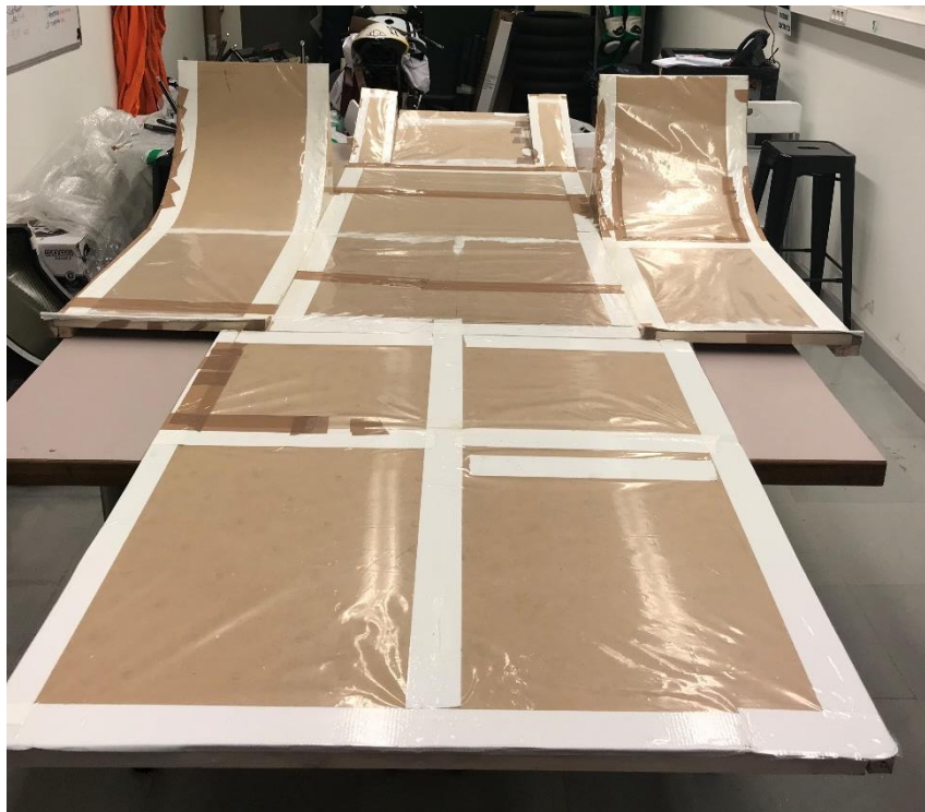
Figura 65 Plastificación del molde
