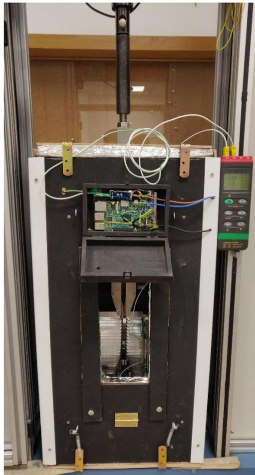
Figura 7: Cámara térmica finalizada acoplada a la máquina universal de ensayos de tracción Elib-20
