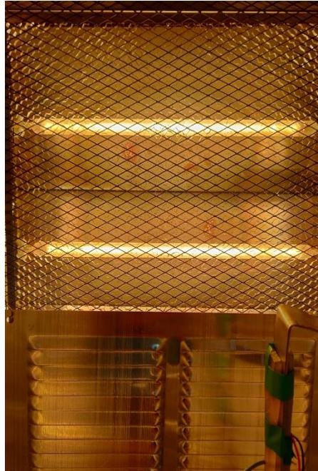
*Figura 20: Tubos incandescentes en funcionamiento*
