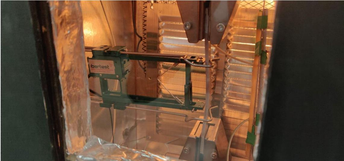
*Figura 48: Ensayo de tracción realizado a alta temperatura*
