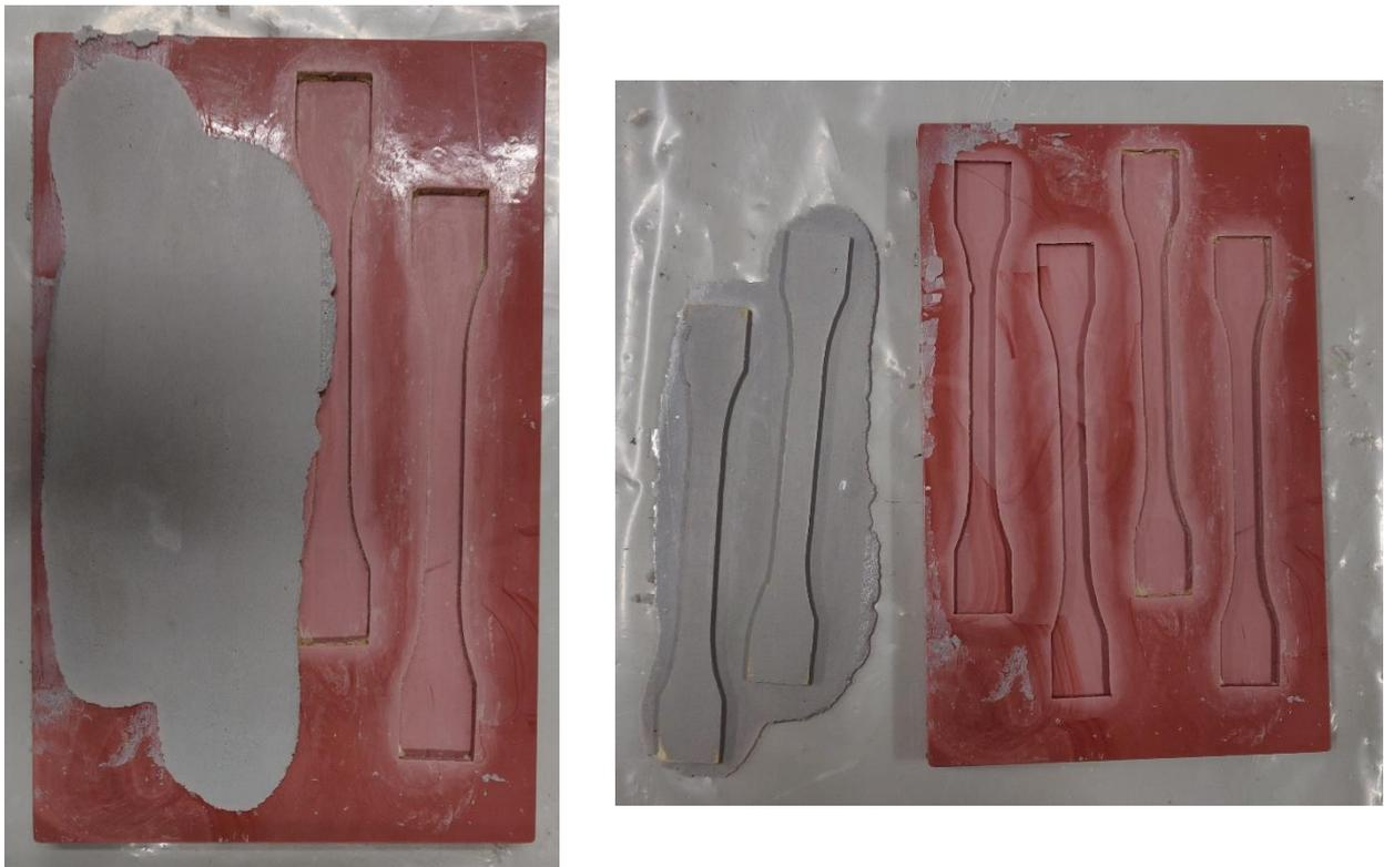
*Figura 37: Desmoldeo de probetas de tipo 1B*
