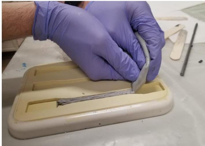
*Figura 36: Proceso de moldeo de probetas tipo 1B*
