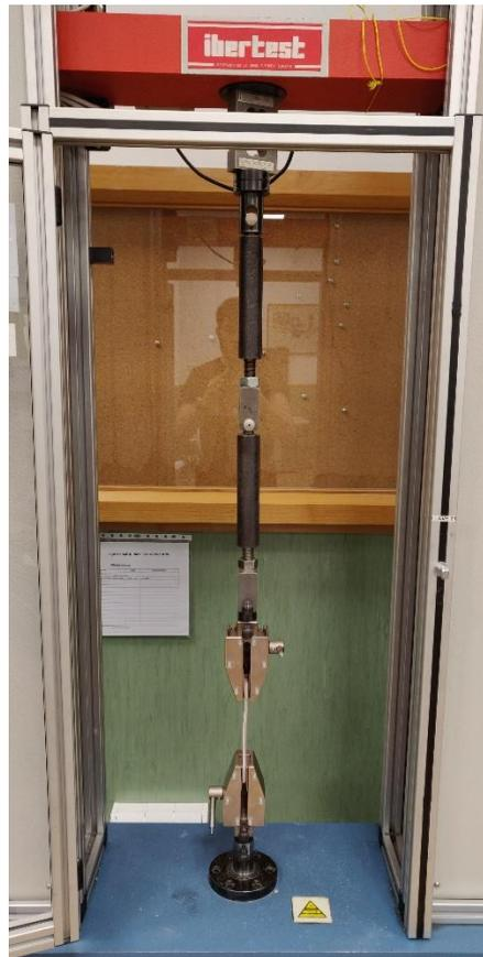
Figura 10: Montaje de mordazas para el ensayo de tracción.
