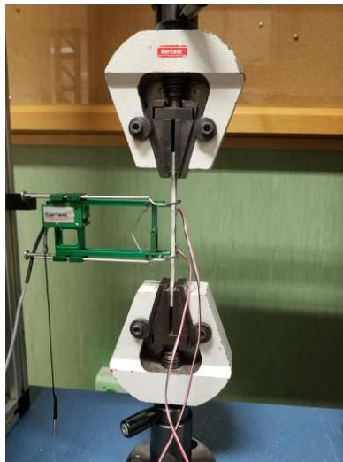
Figura 1: Ensayo de tracción con probeta de adhesivo en masa
