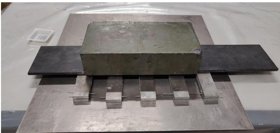
*Figura 42: Probetas DCB en fase de curado*
