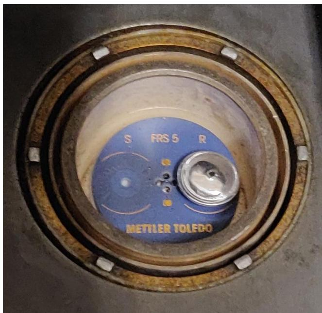
Figura 46: Región de ensayo del equipo DSC822 con probeta de referencia.
