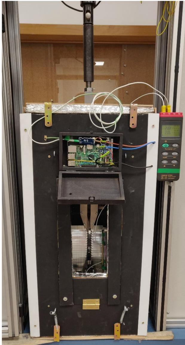
Figura 19: Cámara térmica acoplada a la máquina de tracción universal Elib\_20
