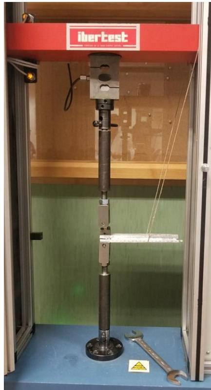
*Figura 12: Disposición del ensayo DCB*
