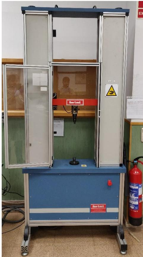
Figura 13: Máquina universal de ensayos de tracción Elib 20
