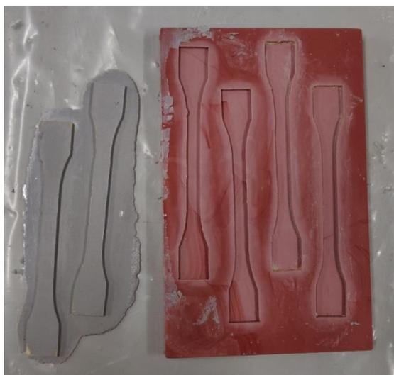
*Figura 8: Proceso de moldeo del adhesivo Sikadur30 en moldes de silicona*
