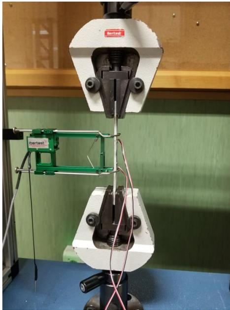
Figura 41: Montaje para la realización de un ensayo de tracción con extensómetro y galgas extensiométricas.
