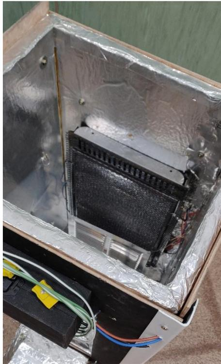
*Figura 17: Tubos incandescentes de la cámara térmica*
