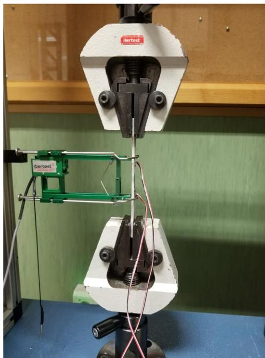
Figura 1: Esquema de montaje de ensayo de tracción con extensómetro
