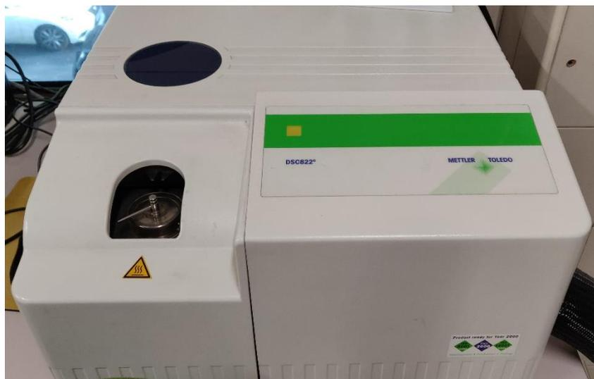
Figura 45: Equipo de ensayo de calorimetría diferencial de barrido DSC822
