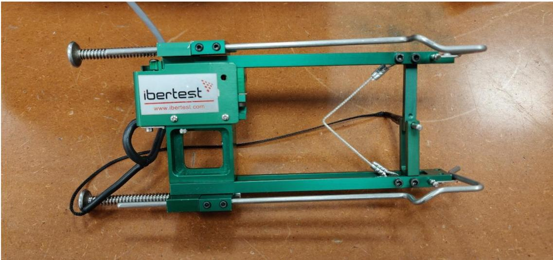
Figura 39: Extensómetro longitudinal 3542-050M-050\_ST
