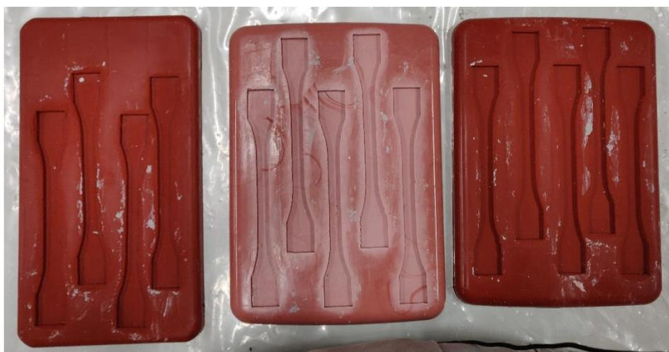
*Figura 35: Moldes de silicona para la preparación de probetas*
