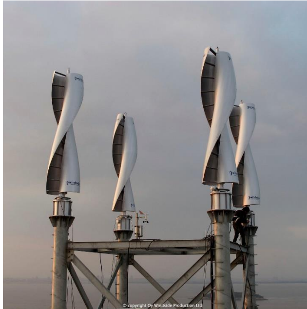
Figura 2-2. Aerogeneradores tipo Savonius. FUENTE: (11).
