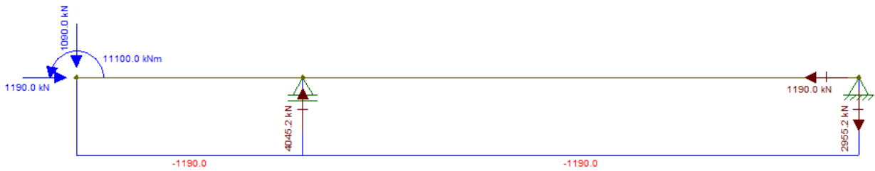
Figura 6-6. Diagrama de esfuerzo axil para el plano XZ. FUENTE: elaboración propia.
